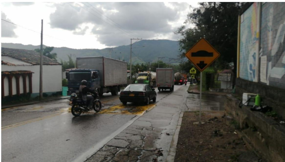
*Intersección peligrosa debido al mal estado de la infraestructura vial, mal mantenimiento de las señales horizontales que dificulta la visibilidad de las mismas. Alto índice de accidentalidad identificado.*
